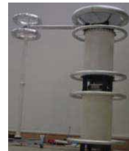
高電圧発生装置
