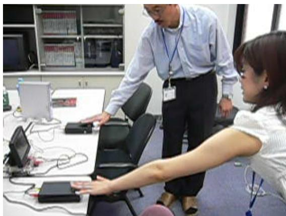
は人が電極に触れることにより人体に微弱電流を流し、その電流に情報を乗せて通信を行う。は送りたい情報で人体表面に沿う電界に変化を与え通信を行う。このとき、人は直接、電極に触れる必要はなく、電極に手をかざしたり、または靴を履いていても地面側の電極と人体間で通信ができる。は従来の近距離無線であるが、低消費電力無線端末を用い、人体から 3m 程度の通信エリアで通信を行うもので、これも広い意味での人体通信とする。は弾性波方式（超音波方式）による人体通信で、拓殖大学の前山利幸氏のグループが研究を行っている。人体通信はセキュリティー性が高く、送信電力が少ないことが特徴である。
