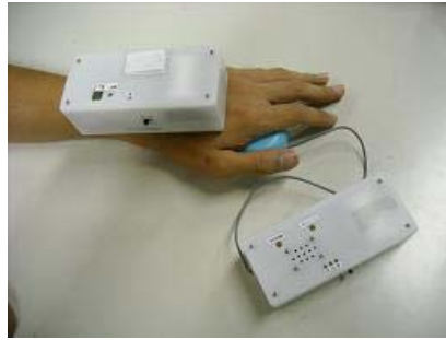
弾性波(超音波)方式 人体通信の試作機 (写真提供 : 拓殖大学 前山 利幸 氏)
