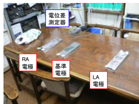
非接触電極の心電計ベッド
