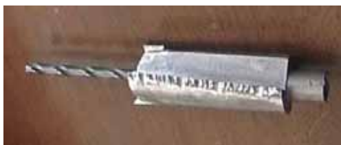
試作3:二枚刃:先端にドリル
