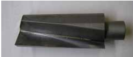
試作1:二枚刃-接触の衝撃が大
