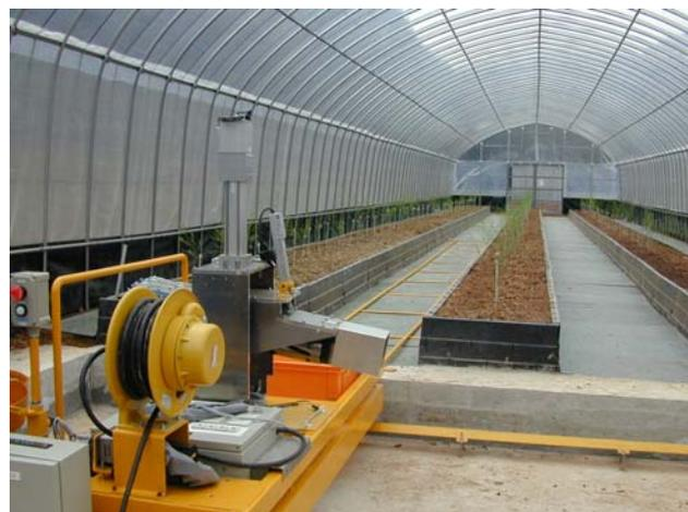
Fig.2 全自動収穫ロボットシステム
