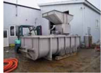
写真5 角氷による移動式シャーベット氷製造装置
