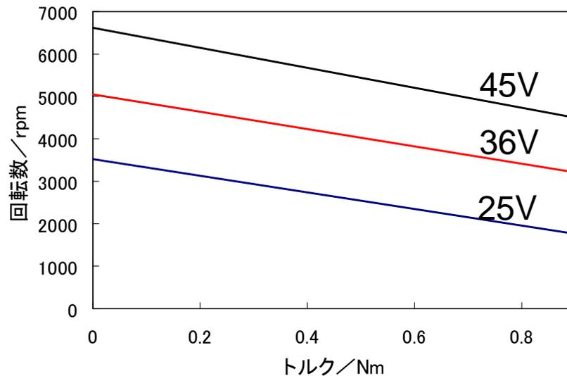
印可電圧により回転数可変140rpm/V
