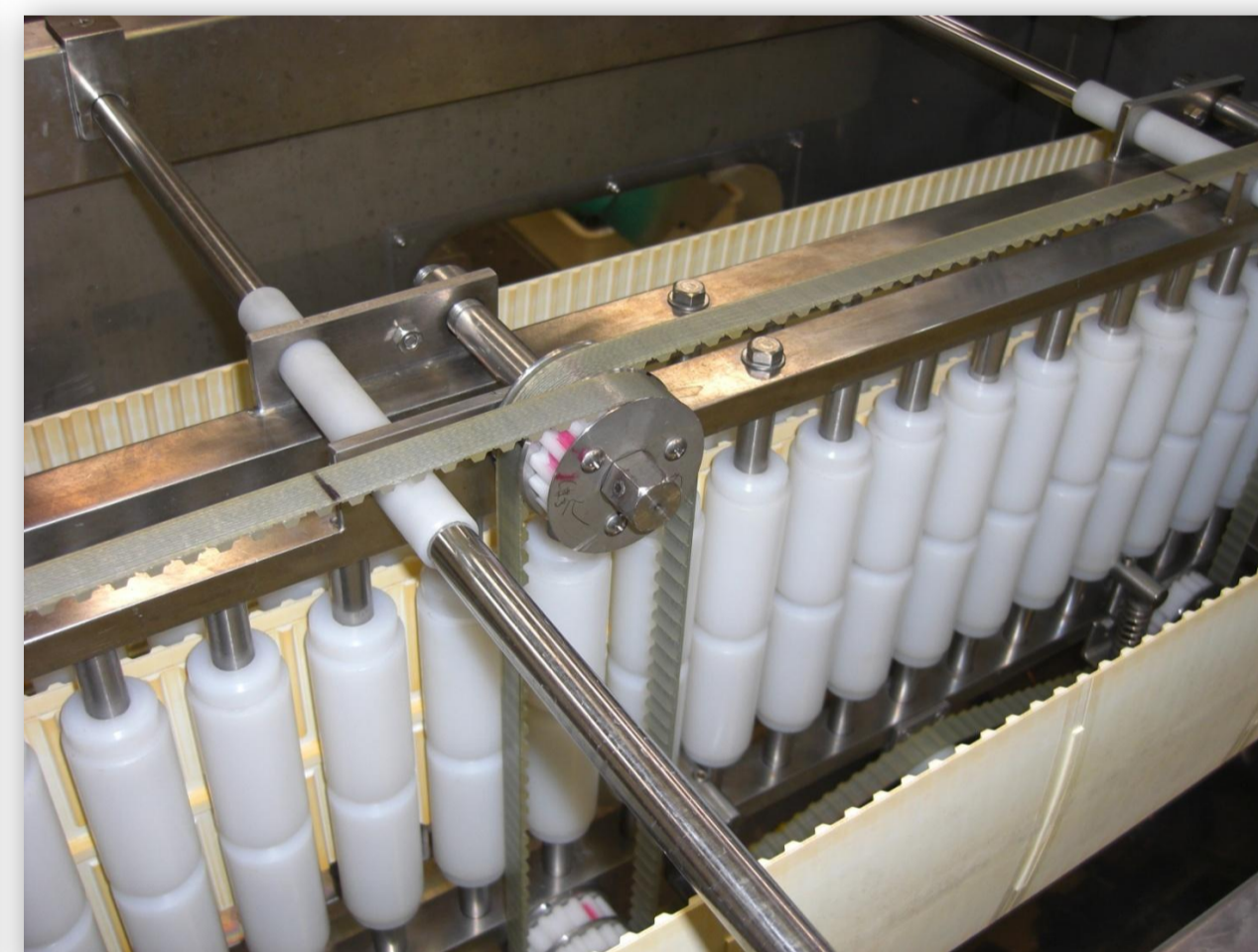
1か所の調整でベルト間距離が可変
