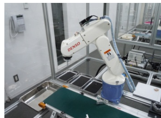
Fig.3 LabVIEWによる制御が可能なロボット。自動制御講習にも活用
