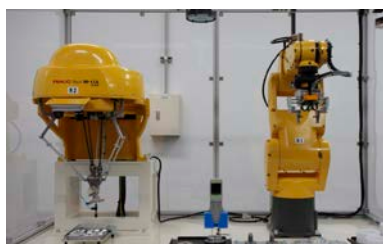
Fig.2 産業用ロボットを用いた器用な耐久試験設備（左：A、右：B）
