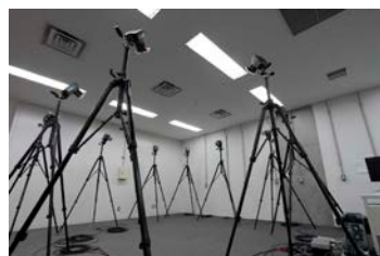
Fig.5 10台のカメラで約500Hzで撮像可能なモーションキャプチャ
