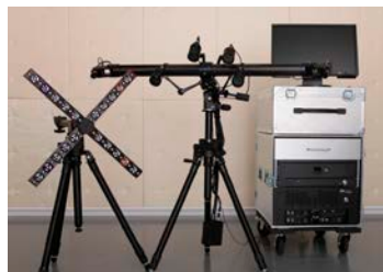
Fig.4 ステレオ視高速度カメラを用いた3次元変位解析システム
