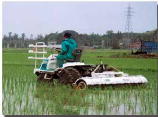
田植機に除草ユニットを付けた機械
