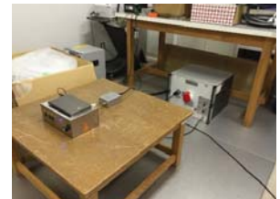
(c) 雑音端子電圧試験の様子
