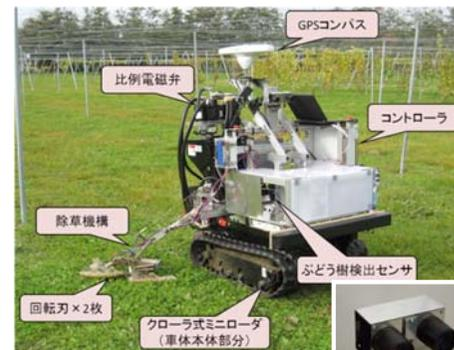
開発した除草作業支援ロボット ステレオビジョンセンサ
