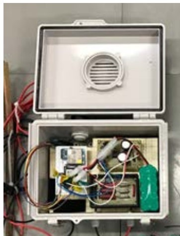
漏電通報装置
