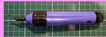
手作業バリ取り工具 (ブレード式) ×30倍
