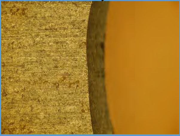
画像処理との連携によるロボットバリ取り ×30倍
